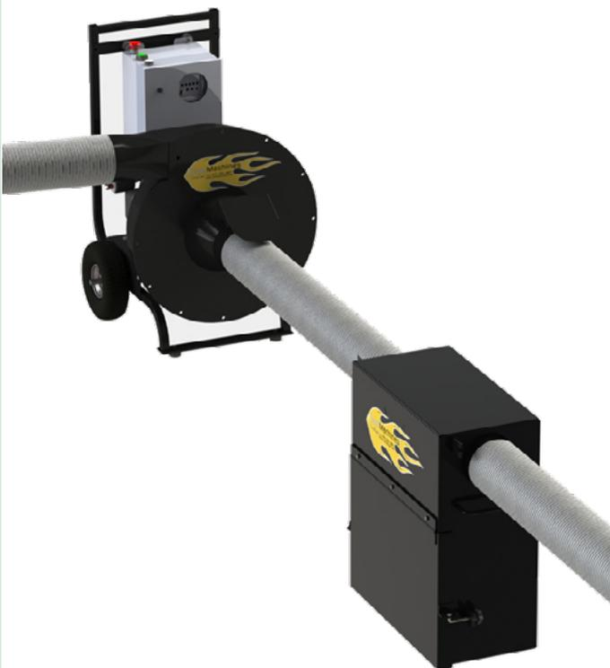
Schutzbox um Schäden am Lüfter der Vac Industriesauger zu vermeiden.
